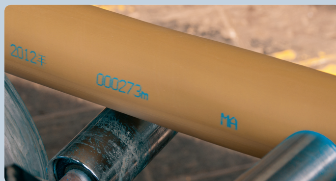
在大规格电缆上的高对比度喷墨喷码
